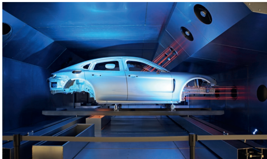
Im Trockner EcoInCure strömt die heiße Luft ins Innere der Karosserie und sorgt so für eine optimale Wärmeübertragung auf schwer zugängliche Teile.
